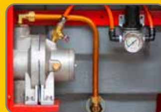
Detail van membraanpomp en drukregelaar.
