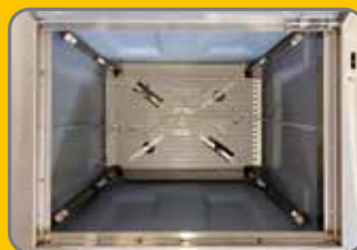
Bovenaanzicht van de spoelbak met 2 houders voor verfpistolen en 2 voor verfbekers.
