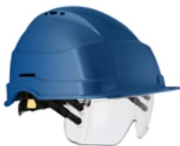
Casque de sécurité. Coque en ABS. Harnais avec 6 points d'attache. Bandeau réglable (49 à 63 cm) avec molette. Ouvertures latérales pour accessoires. Livré pré-monté. Livré avec LUNIRIS2.
