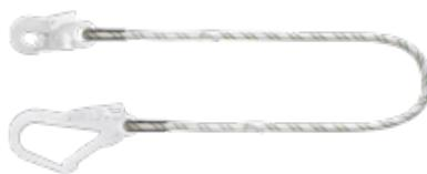
Longe en corde polyamide tressée diam 12 mm. Boucles cossées pour une meilleure résistance à l'abrasion. Coutures protégées sous gaine transparente permettant également un contrôle visuel des coutures. Mousquetons : 1 mousqueton acier à verrouillage automatique FA5020217 et 1 mousqueton d'échafaudage à verrouillage automatique FA5020755 aux deux extrémités
