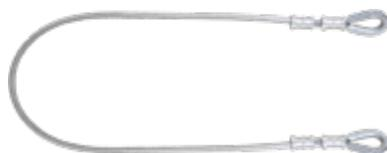
Conçue pour être utilisée sur des structures à angles vifs. Câble acier galvanisé diamètre 8 mm extrémités cossées avec gaine de protection PVC.
