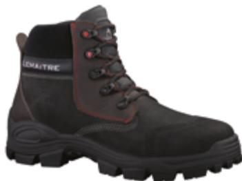
Semelle Parabolic à effet anti-fatigue, Chaussant mixte adapté à la morphologie du pied féminin du 35 au 39 et du pied masculin du 40 au 49, 0% métal. Tige : cuir pull-up hydrofuge avec surbout renforcé anti-abrasion, languette avec soufflet. Doublure : textile tridimensionnel micro-aéré, haute respirabilité. Semelle : trail / PU2D. Embout : HDFC Fibre composite. Insert anti-perforation : textile haute ténacité "0" pénétration.
