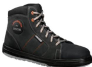
Le sneaker SAXO S3 assure un maintien optimal de la cheville et la protection des malléoles. En version basse : SOUL S3. Tige : cuir hydrofuge finition nubuck. Doublure : textile tridimensionnel micro-aéré, haute respirabilité. Semelle : Street / PU2D. Embout : aluminium. Insert anti-perforation : textile haute ténacité "0" pénétration.
