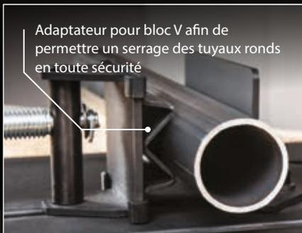
Adaptateur pour bloc V afin de permettre un serrage des tuyaux ronds en toute sécurité
