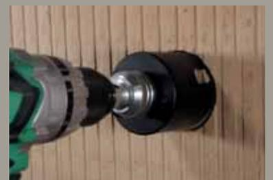
Permet d'utiliser 2 scies trépan en simultanées pour améliorer le centrage ou agrandir un trou existant. Percez en insérant le foret dans le pré-trou.
