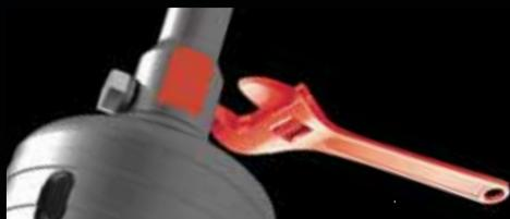
Démontage facile du foret centreur avec une clé 6 pans via la vis hexagonal et du porte trépan avec une clé à molette via le méplat.
