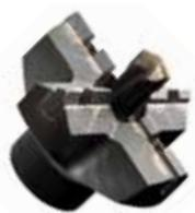
Tête plaquettes carbures à 4 taillants Power Max avec foret centreur permettant le perçage sur des profondeurs de plus de 1m. Grande polyvalence avec possibilité de monter des têtes de perçage Ø32 à 80mm ou des trépan carbure Ø30 à 125mm.
