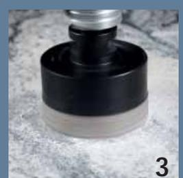
1. Réalisez un pré-trou avec le foret monté sur perceuse via le système onehand. 2. Puis montez en simultanée le foret et la scie-trépan (enlevez au préalable le connecteur du foret) sur le pilote OneHand. 3. Percez en insérant le foret dans le pré-trou.
