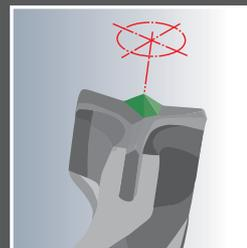
Grâce à sa pointe auto-centrante les efforts de percussion sont canalisés dans l'axe de perçage.
