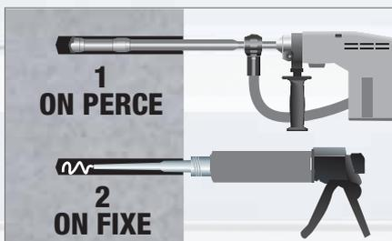
Le perçage et le nettoyage des trous se font en une seule étape. La résistance à l'arrachement des fixations chimiques est décuplée grâce aux trous parfaitement propres. Il y a un réel gain de temps et une plus grande rentabilité des chantiers.
