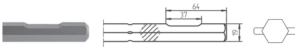
**Hexagonal 19 mm + extrémité cylindrique Ø16,5x35 mm (réf.324)**
