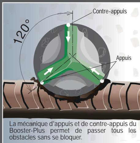
La mécanique d'appuis et de contre-appuis du Booster-Plus permet de passer tous les obstacles sans se bloquer.
