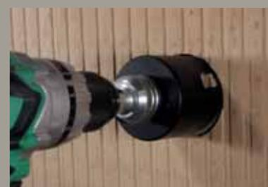
Permet d'utiliser 2 scies trépan en simultanées pour améliorer le centrage ou agrandir un trou existant. Percez en insérant le foret dans le pré-trou.
