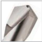
Foret long brasé à très haute température pour un usinage de précision. Composé d'un corps en acier rapide avec plaquette carbure K20 et d'une hélices à droite (25°).
