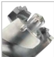
Tête plaquettes carbures à 3 taillants Power Max avec foret centreur permettant le perçage sur des profondeurs de plus de 1m. Grande polyvalence avec possibilité de monter des têtes de perçage Ø45 à 80mm.
