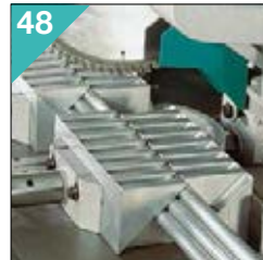
48 VELOX Mâchoires en V en aluminium. Tenazas a V en aluminio.
