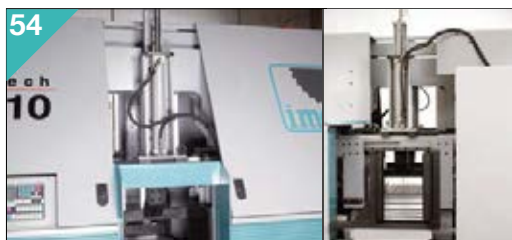
54 AUTOMATIQUES SERIE MAXI - AUTOMATICAS MAXI SERIES Dispositif hydraulique coupe en paquet. Aparato hydraulico para corte a paquete.
