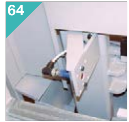
64 Laser pour le démarrage intelligent. / Laser para l'em- pezo de corte intelligente.
