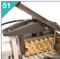
51 Dispositif hydraulique coupe en paquet. Aparato hydraulico para corte a paquete.
