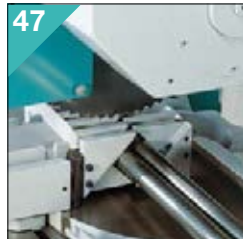
47 SIRIO Mâchoires en V en fonte. Tenazas a V hierro fundido.
