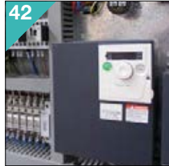
42 Variateur vitesse lame. Variador velocidad hoja.
