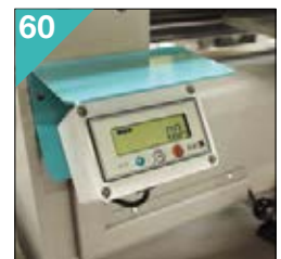
60 Ecran visualisation angle. Pantalla visualizacion angulo de corte.
