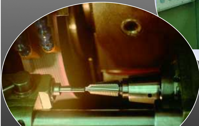
Hinterschleifen von Stufenbohrern auf Maschine mit DÄMO- CNC-Steuerung
