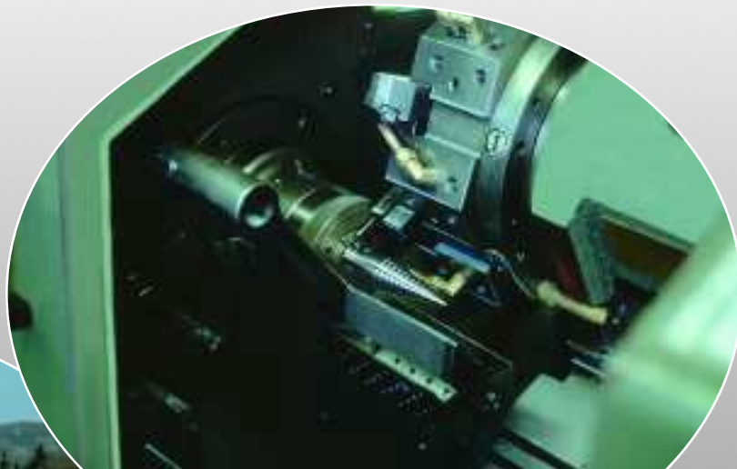
Einer unserer CNC-Drehautomaten beim Drehen von Stufenbohrern
