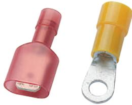
Les cosSES pré-isolées sont réalisées à partir d'un méplat de cuivre étamé, qui assure une adhésion parfaite de l'étain sur la surface des cosSES. Le recuit en fin de fabrication garantit les caractéristiques mécaniques des cosSES, assurant ainsi stabilité, facilité de sertissage et absence de microcassures.
