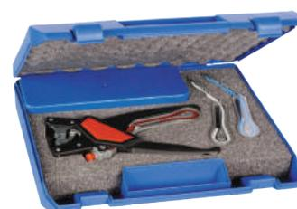
Outil automatique très ergonomique pour le sertissage des embouts en bandes des sections 0,5 à 2,5mm<sup>2</sup>. Cet outil est fourni dans une boîte pratique équipée de trois chargeurs et d'un étui pour embouts en bandes. Ces caractéristiques universelles lui permettent de saisir, de couper, de dénuder et de torsader les câbles puis de sertir les embouts.
