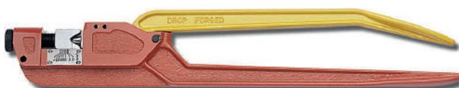
L'outil est en acier trempé, les têtes brunies et les manches en plaqué acier. Adapté pour sertir, manuellement, des cosse tubulaires standards et NFC de sections allant de 10 à 95 mm<sup>2</sup>.
