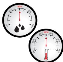
Pour une conservation correcte de colliers de câblage, il est recommandé de les entreposer dans une pièce où la température sera comprise entre 10 et 40 °C, avec une humidité relative comprise entre 30 et 70%.
