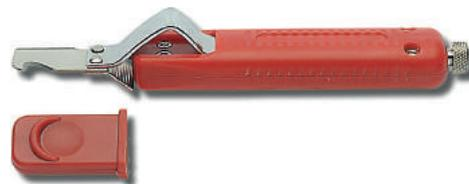
Couteaux à dénuder pour câbles ronds, dont le corps est en matière plastique avec quelques parties en métal chromé. Lame réglable en acier trempé. Lame-crochet en acier. Adapté pour des conducteurs de diamètre extérieur de 8 à 28 mm.
