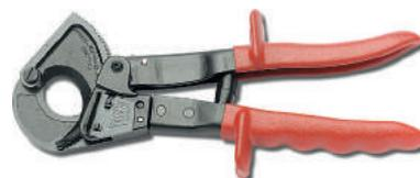
Coupe câble avec des poignées vernies en métal, avec un dispositif à cliquet pour l'avancement des lames de coupe en acier traité et manche en plastique. Indiqué pour la coupe de câbles en cuivre et en aluminium avec section jusqu'à 300 mm<sup>2</sup>.
