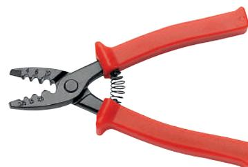
Pince à sertir pour embouts pré-isolés en métal avec manches en plastique et ressort de re-ouverture. Appropriée pour embouts de 0,75 à 10mm<sup>2</sup>. (AWG 18 ÷ 8)
