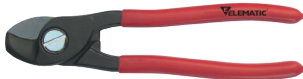
Cette pince permet de couper des conducteurs cuivre ou aluminium d'un diamètre max de 15 mm (~50 mm<sup>2</sup>). Réalisé en acier forgé, avec des lames de précision aiguisées et trempées.
