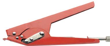
Pince pour colliers de câblage et d'installation de 3,5 à 13 mm de largeur. Cet outil est composé d'un corps en acier embouti verni. Il développe un serrage réglable manuellement en fonction de la force utilisée. La coupe du collier est réalisée au travers d'un levier approprié.
