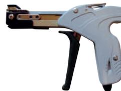
Cet outil en métal est doté d'un système de réglage qui permet de déterminer la tension de serrage. Une fois le niveau de tension souhaité obtenu, son système automatique coupe le collier sans effort ni bavures. Approprié pour colliers de largeur de 7,9 mm maximum.
