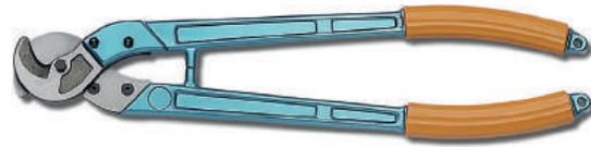
Coupe câbles manuel avec poignées en plastique et lames en acier. Approprié pour couper les câbles en cuivre et aluminium d'une section maximale de 250 mm<sup>2</sup>.
