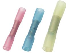
Les manchons pré-isolés sont composés d'un petit tube en cuivre recouvert d'un tube thermorétractable avec un adhésif spécial à l'intérieur. Le polymère utilisé pour les isoler est approprié pour être sertir, avec l'outillage adéquat.
