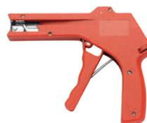
Pince pour colliers de câblage de 2,2 à 4,8 mm de largeur. Cet outil dispose d'un système de serrage et de coupe automatique des colliers. Doté d'un système de réglage, cet outil permet de déterminer la tension de serrage.
