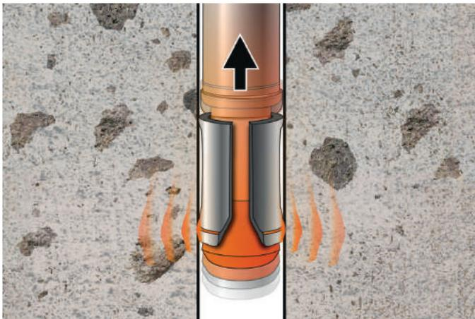
**Haute tenue et répartition de la charge :** Nouvelle chambre d'expansion et angle du cône réduit.
