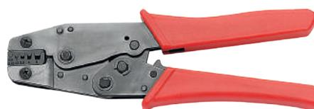
Outil professionnel en acier trempé, sertissage latéral et manches en plastique, dispositif de réglage du serrage des matrices. Système de fermeture à cliquet des poignées et réouverture automatique lorsque l'opération de sertissage est réalisée. Recommandé pour les embouts nus et isolés de 0,5 à 6 mm<sup>2</sup> (AWG 22÷10).
