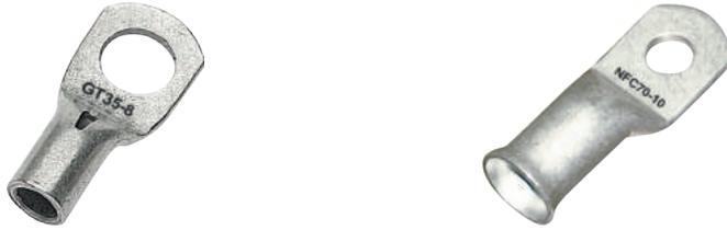
Les cosses tubulaires Elematic sont en cuivre étamé et recuit (99,9%), à haute conductivité; elles sont pourvues d'un trou d'inspection du conducteur. Une indication sur chaque cosse informe de la section du câble et du diamètre de la vis.
