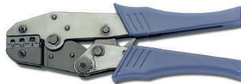
Cette pince est en acier trempé, les têtes brunies et les branches en plastique. Équipé d'un dispositif de sécurité, Adaptée pour des cosses à fût ouvert et clips non-isolés de sections allant de 0,5 à 6 mm<sup>2</sup>.
