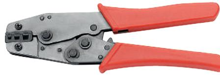
Outil professionnel en acier trempé, sertissage latéral et manches en plastique, dispositif de réglage du serrage des matrices. Système de fermeture à cliquet des poignées et réouverture automatique lorsque l'opération de sertissage est réalisée. Recommandé pour les embouts nus et isolés de 6 à 16 mm<sup>2</sup> (AWG 10 ÷ 6).
