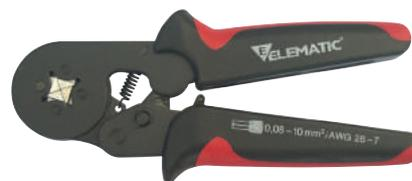
Pince à sertir automatique, en acier trempé avec les têtes brunies, et les branches ergonomiques en plastique, garantissant un sertissage carré avec chargement latéral de l'embout.
