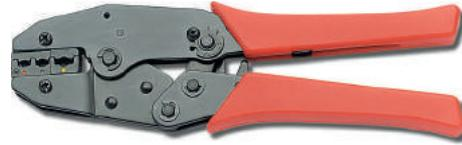
Outil en plaque d'acier trempé, avec des matrices en microfusion, manches en plastique. Dispositif de réglage du serrage des mâchoires, système à cliquet pour une parfaite fermeture des poignée et desserrage automatique lorsque l'opération de sertissage est réalisée. Indiqué pour des cosses pré isolées de 0,5 à 6 mm<sup>2</sup>.
