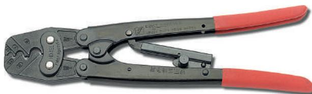
Outil en acier trempé, têtes brunies et branches isolées en PVC antidérapant. Un système de crimaillère de sécurité (déverrouillable) garantit un sertissage fiable. La pression de sertissage est réglable pour un sertissage optimal. Adapté pour sertir, manuellement, des cosse tubulaires et NFC de sections allant de 1,5 à 16 mm<sup>2</sup>.
