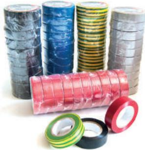
Les rubans isolants en PVC sont disponibles en différentes épaisseurs, longueurs et couleurs. Le matériel est auto-extinguible et permet une bonne isolation électrique et une protection mécanique pour des usages dans des installations civiles et industrielles. Les caractéristiques spéciales de l'adhésif et du support PVC garantissent un pouvoir isolant élevé, (600 V), et ils en permettent aussi l'emploi en conditions critiques ( basses températures, sollicitations mécaniques élevées).
