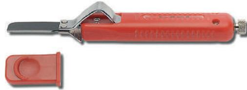
Couteaux à dénuder pour câbles ronds, dont le corps est en matière plastique avec quelques parties en métal chromé. Lame réglable en acier trempé. Couteau fait d'une lame en acier chromé. Adapté pour des conducteurs de diamètre extérieur de 8 à 28 mm.
