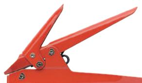
Pince pour colliers de câblage et d'installation de 3,5 à 9 mm de largeur. Cet outil est composé d'un corps en acier embouti verni. Il développe un serrage réglable manuellement en fonction de la force utilisée. La coupe du collier est réalisée au travers d'un levier approprié.
