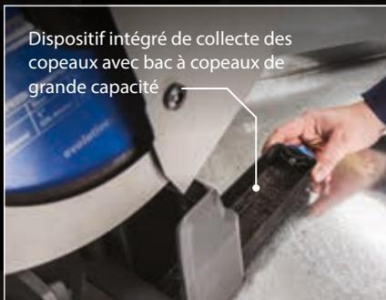
Dispositif intégré de collecte des copeaux avec bac à copeaux de grande capacité
